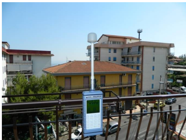
Strumento di misura di campi elettromagnetici in radiofrequenza per la verifica del non superamento dei valori limite di legge
