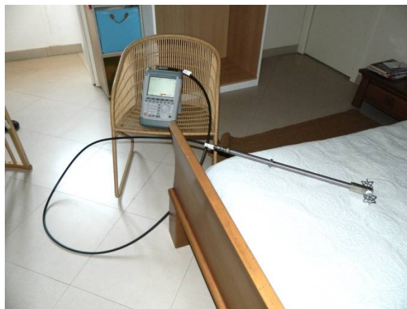
Strumento comprensivo di antenna per la misura di campi elettromagnetici in radiofrequenza secondo principi precauzionali
